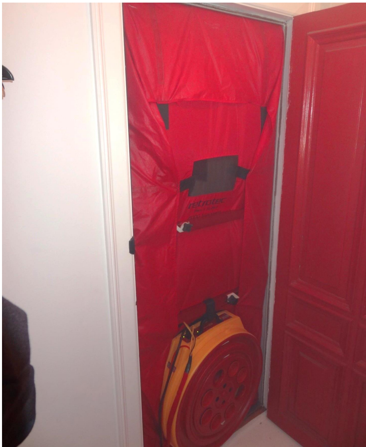
Blowerdooren ses her opstillet i entréen, med udblæsning til trappeopgang.
